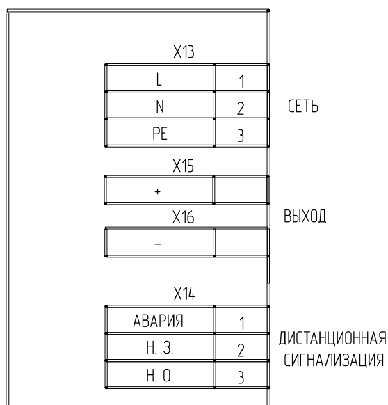
Рис.7.3. Схема подключения выпрямителей ВБВ 60/6-МК, ВБВ 48/7-МК, ВБВ 24/12-МК для самостоятельной работы (в кожухе)
